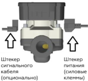
2. Подключите разъемы в соответствующие отверстия и надежно зафиксируйте в разъемах.
