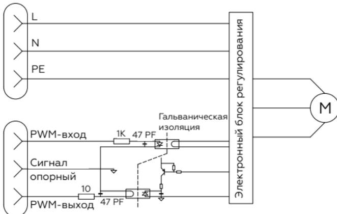
Входной сигнал PWM (P1 – отопление).
