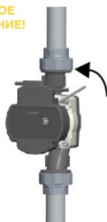
5. Установите панель в желаемое положение, затяните болты.
