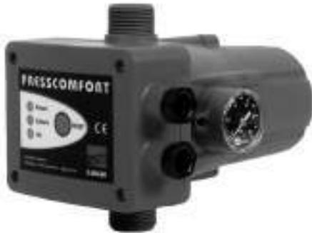
Это автоматическое электронное устройство управляет электрическими насосами в системах без накопительных емкостей. Оно автоматически включает и выключает насос при открытии или закрытии любого вентиля в системе. После запуска насос продолжает работать, пока идет отбор воды из сети, обеспечивая необходимую подачу. При отсутствии воды на входе он автоматически выключится.
