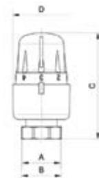
**Термостатический вентиль проходной, с предварительной настройкой**
