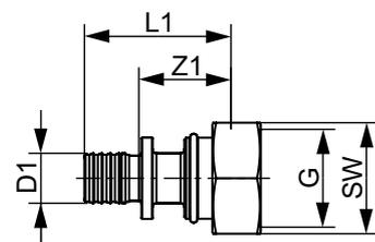
**Соединение прямое с внутренней резьбой (накидная гайка, Евроконус)**
