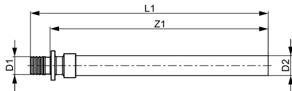
**Соединение прямое с внутренней резьбой никелированное (накидная гайка, Евроконус)**
