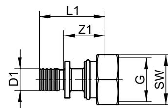
**Концовка разборная 3/4" (Евроконус) для универсальной металлополимерной трубы**
