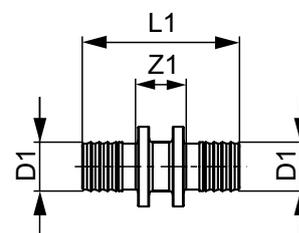
**Соединение труба-труба редукционное**
