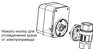
Способ фиксации арматуры (рис. 2)
