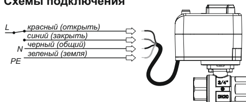
Электрическая схема подключения крана с электроприводом серии Neptun Bugatti Click 230B (рис. 3)
