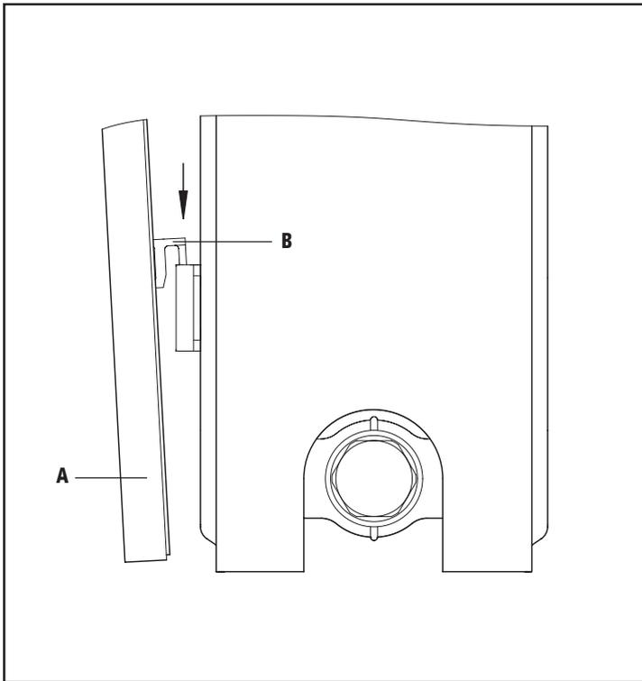
**11 Strahlungsschirm (A) am Heizkörper montieren.**
