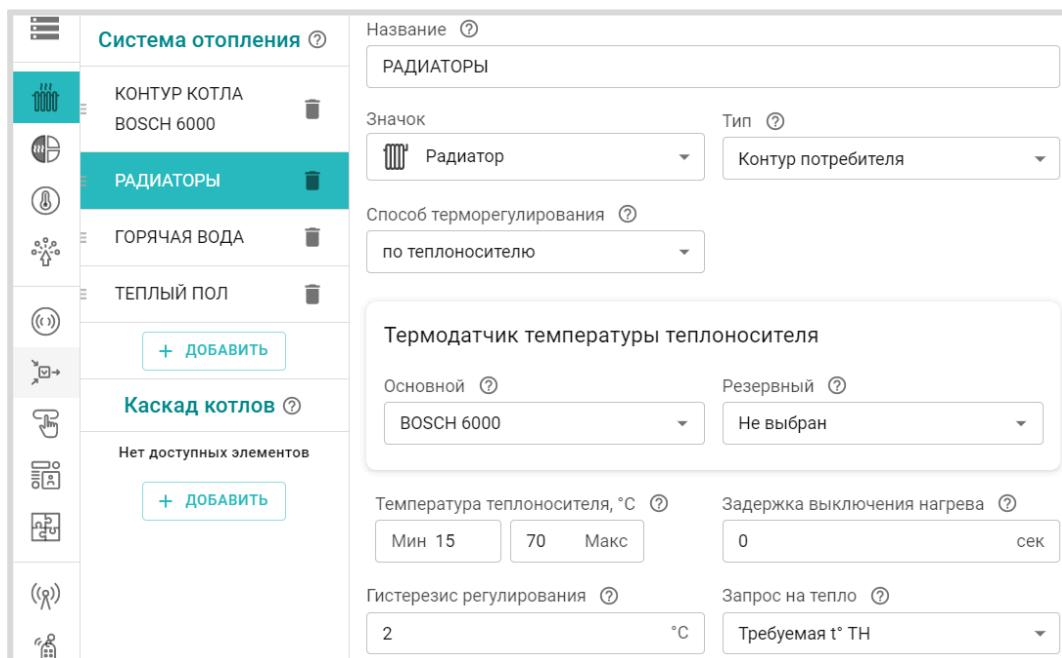
**Тип контура** – Контур потребителя;
