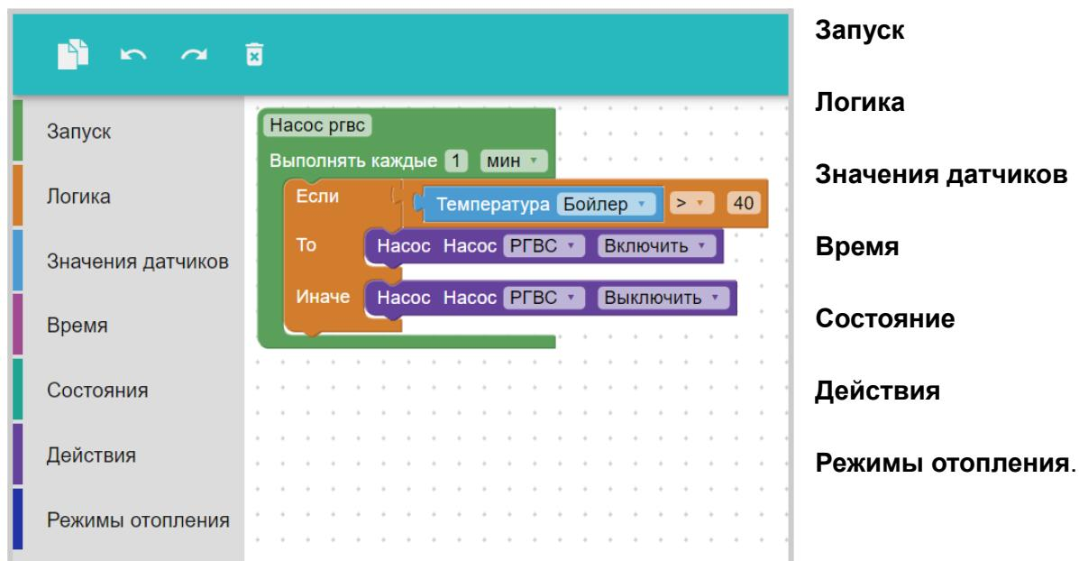
В каждый блок автоматически подгружаются режимы, команды, действия с выходами, контролируемые датчики, параметры и события из конфигурации Контроллера. Поэтому прежде чем составлять сценарий, надо проверить все ли необходимое предусмотрено в ней.
