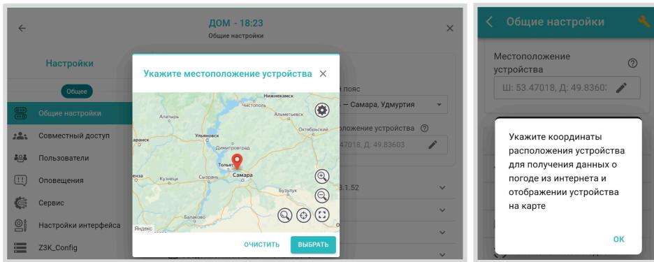
**Примечание:** Информацию об уличной температуре Контроллер может получать только из одного источника. Функция контроля температуры по данным с погодного сервера доступна при условии, когда ни один из датчиков в конфигурации контроллера не используется как "Уличный датчик". Это относится и к настройкам исполнительного устройства Адаптер цифровой шины, в котором тоже не должен быть активирован параметр "Уличный датчик".
