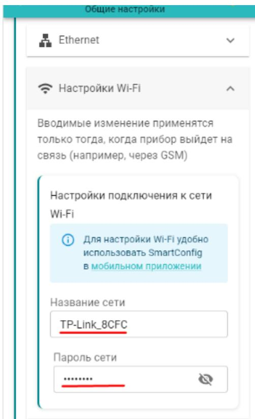
Если в Контроллер уже установлена активная Сим-карта и связь с сервером по GSM есть, то для подключения к сети Wi-Fi надо в общих настройках прибора указать название и пароль сети и сохранить введенные данные. Контроллер разорвет соединение с сервером по каналу GSM и установит соединение по сети Wi-Fi. При этом GSM канал связи будет в резерве.
