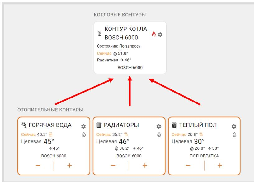
Параметр “запрос на тепло” применяется только в Отопительных контурах, где для поддержания целевой температуры требуется повышать температуру на подаче котла.
