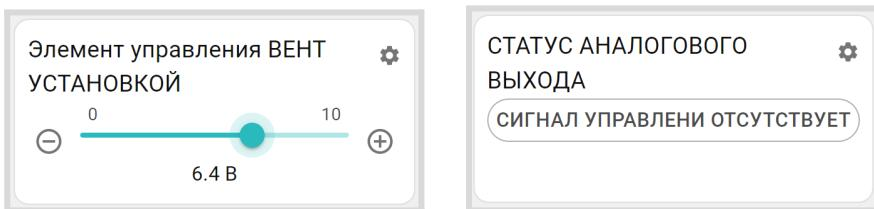
**Примечание:** Статус аналогового выхода будет активен только пока контроллер дает команду приводу на движение. В ручном режиме статус привода будет всегда в пассивном состоянии, т.к. ручная команда мгновенно изменяет состояние выхода с текущего на то, которое выставлено вручную. В режиме тестирования доступно изменение напряжения на аналоговом выходе для проверки правильности подключения и проверки направления движения исполнительного устройства.
