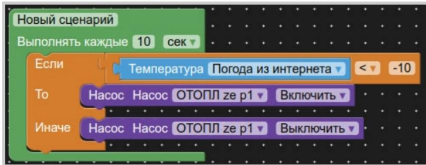
**Пример:** Надо включать насос, только когда температура на улице опускается ниже  $-10^{\circ}\text{C}$ . и выключать его когда она выше  $-10^{\circ}\text{C}$ .
