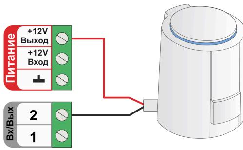
Схема подключения к релейному выходу:
