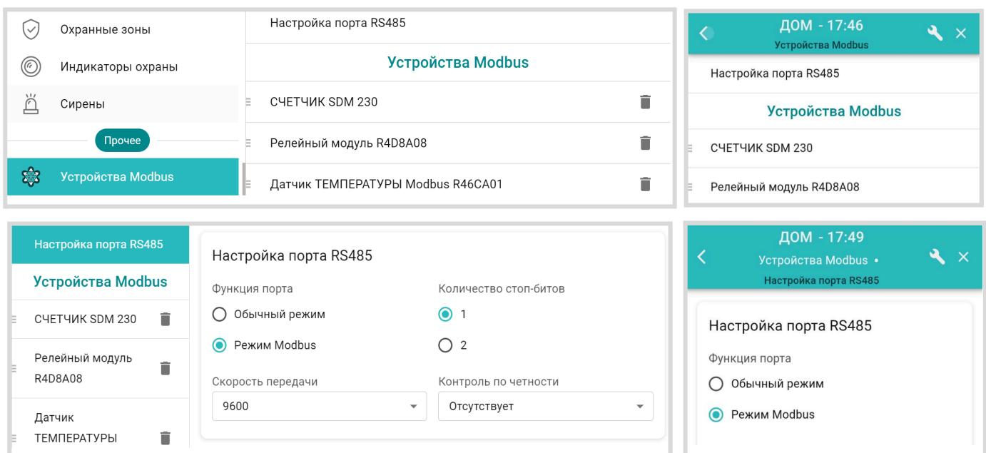
**ВНИМАНИЕ!!!** В Контроллере аппаратно реализованы 2 порта RS-485. Для подключения Modbus устройств предназначен только один, расположенный в нижней части клеммной колодки прибора. Использование второго порта (верхняя часть контроллера) для этой задачи не предусмотрено.
