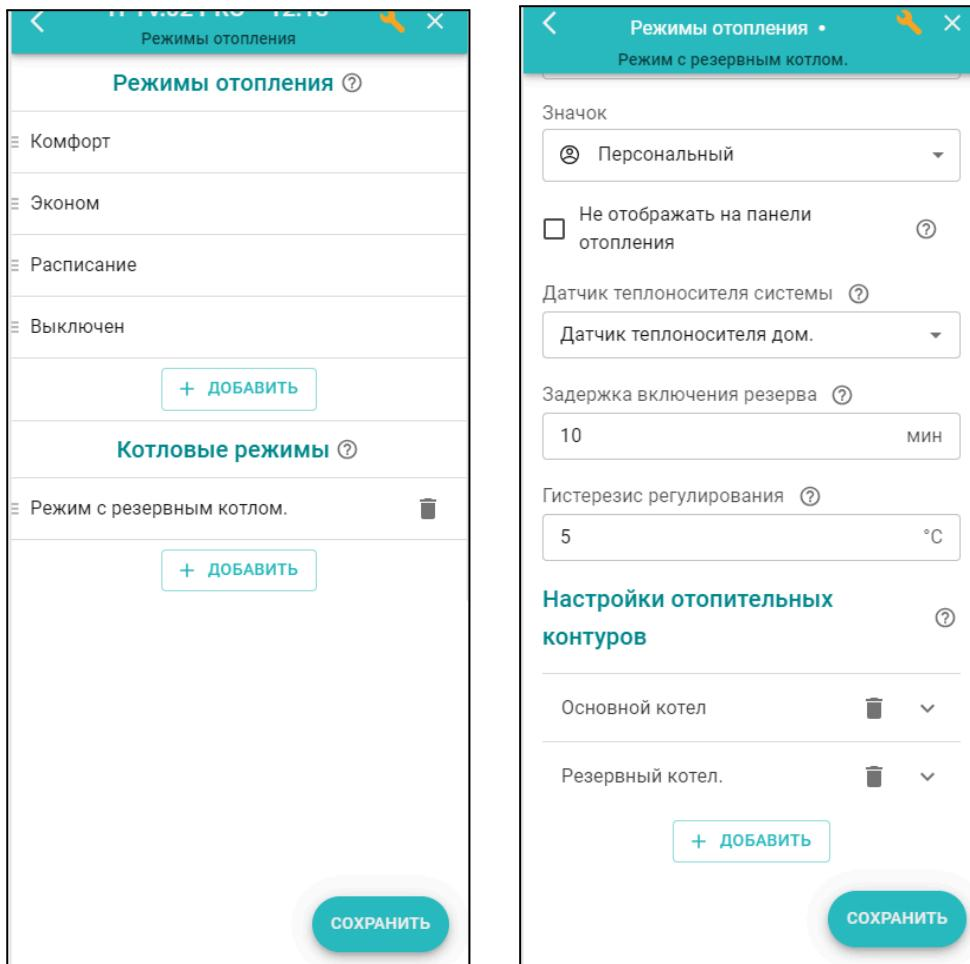
**Датчик теплоносителя системы** – источник информации о температуре подачи теплоносителя в систему отопления. Это датчик температуры, подключенный к Контроллеру и расположенный за гидроизделием.
