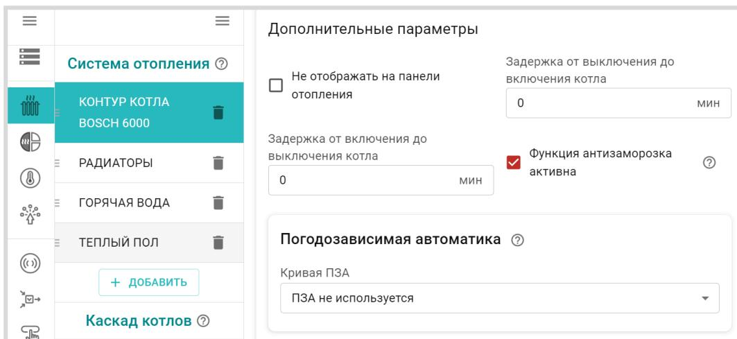
**Не отображать на панели отопления** – скрывает Контур котла на панели управления.
