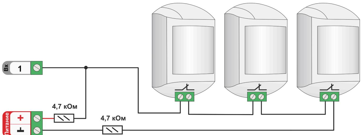
Так как **напряжение питания** на контроллере “**+12 В**”, то для расчета пороговых значений контролируемого напряжения на шлейфе ИК датчиков и определения факта срабатывания используются следующие формулы:
