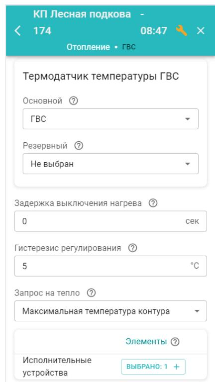
**ВНИМАНИЕ!!!** В контуре ГВС с БКН за гидрострелкой гистерезис поддержания горячей воды отслеживается только в сторону уменьшения от целевой температуры. Т.е. если целевая температура ГВС – 50°C, а гистерезис – 5°C, то запрос тепла в контур котла будет отправляться при температуре горячей воды 45°C и сниматься при температуре 50°C.
