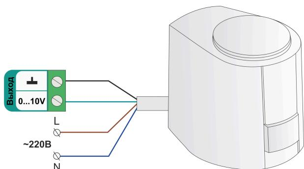
схема подключения такая же как и для приводов запитанных от источников постоянного напряжения.
