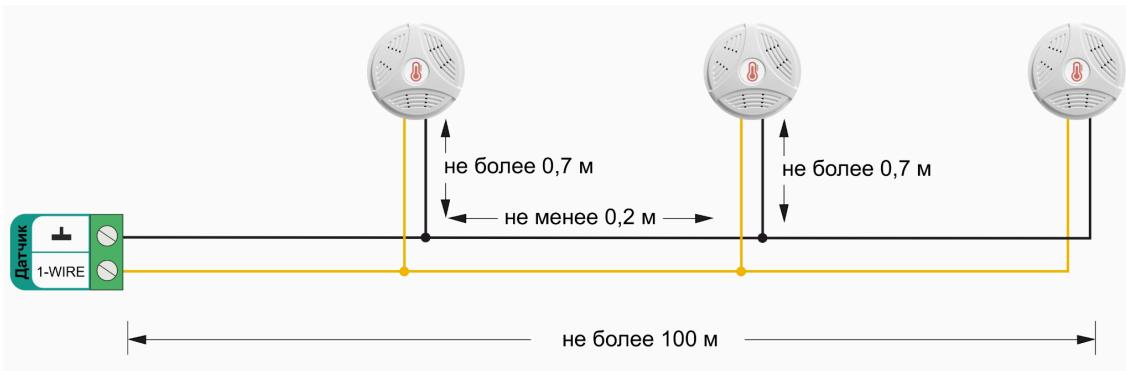
Подключение датчиков по трехпроводной схеме:
