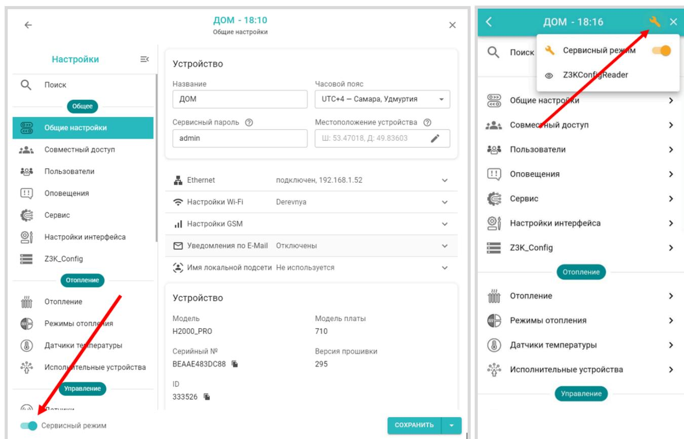
Настройка Контроллера разделена на тематические блоки. Назначение каждого блока и описание настраиваемых в нем функций и параметров можно получить, используя встроенные подсказки, помеченные знаком вопроса
