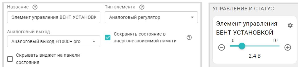
При этом в сервисе, в блоке Управление и Статус будет отображен Элемент управления аналоговым выходом 0-10В. Перемещая ползунок шкалы напряжения, можно менять напряжение на аналоговом выходе и тем самым управлять работой исполнительного устройства вручную.
