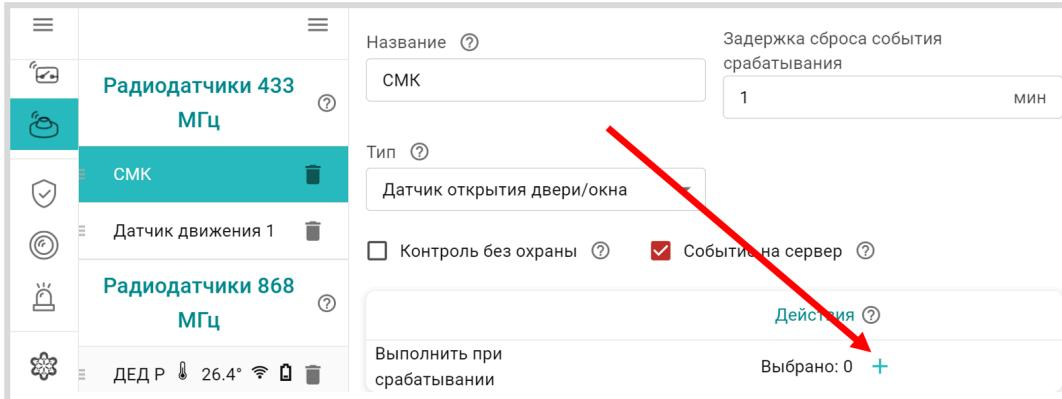
**ВНИМАНИЕ!!!** Необходимо помнить, что стандартные датчики 433 МГц могут отправлять Контроллеру сигнал тревоги только в момент сработки и не отправляют Контроллеру сигналы о дальнейшем своем состоянии. Т.е. если вы используете стандартный датчик открытия двери 433 МГц, то сигнал тревоги датчик отправит после открытия двери. Если дверь не закроется Контроллер не получит повторных сигналов тревоги. Следующий сигнал тревоги датчик отправит только после закрытия двери и следующего открытия двери.
