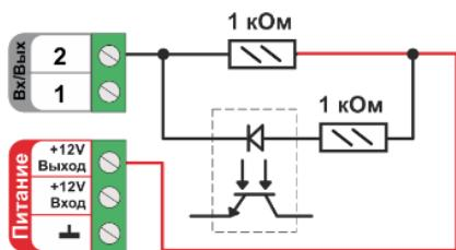
Особенность этой схемы заключается в том, что оптореле может включаться (загорится внутренний светодиод оптрана) даже от малого тока через цепь +3,3 В - 100 КОм - оптрон - +12 В. Чтобы этого не произошло, рекомендуем включить дополнительные резисторы номиналом 1 КОм.
