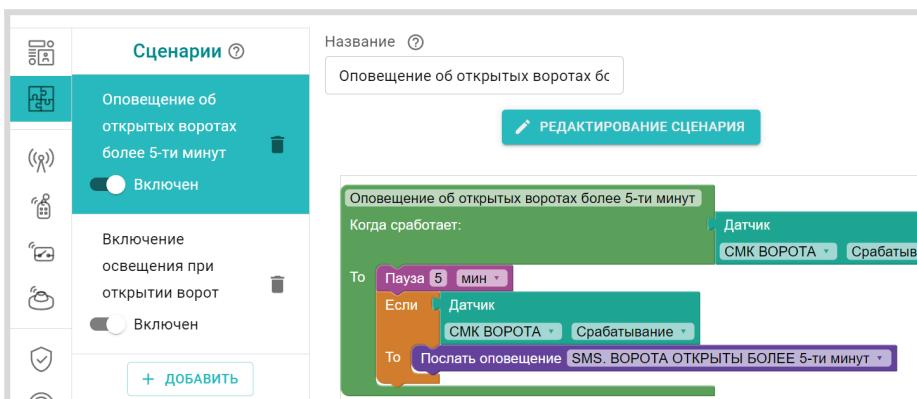
**ВНИМАНИЕ!!!** В сценарии нельзя использовать команды управления выходами Контроллера, назначенными для управления исполнительными устройствами отопительных контуров. Алгоритмы управления и регулирования температуры в конфигурации контроллера имеют высший приоритет и сценарий с такими командами не будет выполняться. Поэтому при составлении сценария рекомендуется использовать управление отдельными выходами Контроллера через блок настроек "Действия с выходами".
