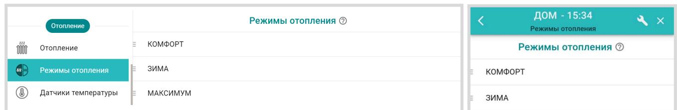
В Режим отопления включаются отопительные контуры (Потребителя и ГВС), где каждому задается целевая температура или вариант работы. Контур может не входить в состав некоторых
