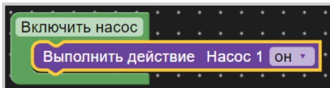
**Запуск по событию.** Такой сценарий будет запускаться автоматически по событию, указанному в блоке “Когда сработает”. Это может быть определенное время, значение контролируемого датчика, например температуры, или что-то другое. Когда событие станет истинным – выполнится инструкция из блока “То”. Таким образом сценарий выполняется без участия пользователя.
