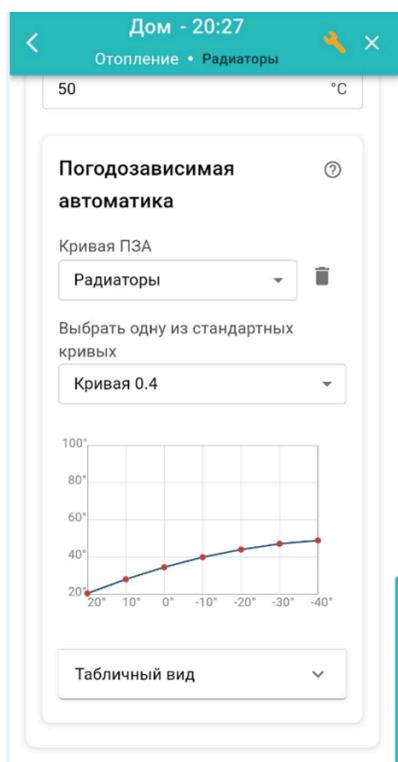
В любом отопительном контуре, кроме контура ГВС, можно задать кривую ПЗА. Выбирается либо одна из стандартных кривых (предустановлены в заводской конфигурации Контроллера), либо настраивается индивидуальная кривая ПЗА (по графику или табличным значениям).
