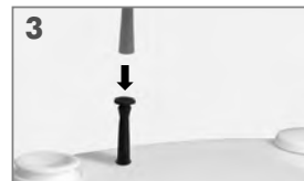
3 Смажьте силиконовой смазкой пневмодатчик перед установкой SANIALARM®
