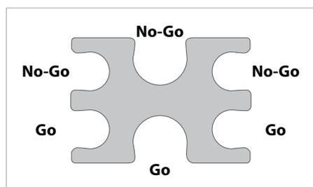
Стальная пластина "Go No-Go" используется для калибровки, чтобы проверить каждую складку обжатой поверхности. При правильной установке и обжатии отверстие "Go" должно свободно проходить вокруг обжатого кольца по всей его ширине и диаметру. Вы не должны применять силу во время проворачивания измерительного прибора. Отверстие "No-Go" не должно проходить и проворачиваться вокруг обжатого кольца. Если обжатое соединение не проходит данный тест, то оно должно быть отрезано вместе с трубой.
