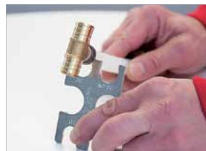
Всегда проверяйте каждое соединение при помощи измерительного прибора.
