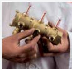
3. Защитные колпачки балансировочных запорных клапанов находятся на передней панели модулей.
