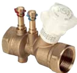
Статический балансировочный клапан с измерителем расхода с калиброванным отверстием (работающий по принципу Вентури) с фиксированным значением коэффициента пропускной способности Kv. С возможностью установки механической памяти для выбранного значения настройки. Версии с ниппелями для подключения измерительного прибора и без ниппелей с отверстиями для возможности установки штуцеров. Максимальная рабочая температура 110 °С. Максимальное рабочее давление 25 бар.
