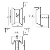
H=22 мм, W=мм, Винт М4-30
