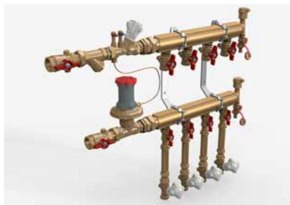
Узел коллекторный отопления для индивидуального учёта тепла, этажный, с общей балансировкой. От 2 до 12 подключений.
