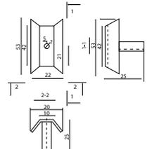
H=22 мм, W=53мм, Винт М4-30
