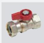
Прямой стандартнопроходной шаровой кран с внутренней резьбой и накидной гайкой с плоской прокладкой, для гидравлических систем, латунный никелированный с алюминиевой флажковой рукояткой.
