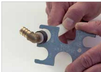
Не проверяйте само соединение, нужно проверять обжатое кольцо.
