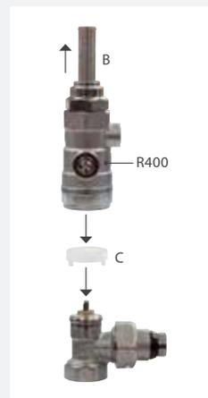
Для клапанов серии PTG имеется возможность демонтажа запорного элемента для замены без сброса давления и останки системы отопления, с помощью специального ключа R400.
