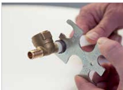
Убедитесь в том, что вы используете отверстие измерительного прибора диаметром, соответствующим данной трубке.
