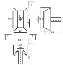
H=22 мм, W= 43 мм, Винт М4-30
