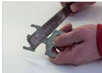
Не модифицируйте измерительный прибор никоим образом. Он должен быть заводского изготовления с погрешностью 0.5 мм.
