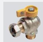
Угловой шаровой кран с наружной резьбой и накидной гайкой с плоской прокладкой, для газопроводов, латунный никелированный с алюминиевой флажковой рукояткой.
