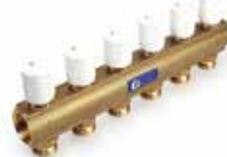
Коллектор распределительный возврата с регулирующими термостатическими клапанами, с отводами с наружной резьбой. Возможна установка электротермической головки (сервопривода) R478, R478M, R473, R473M, на место демонтированных рукояток. Межосевое расстояние: 50 мм.
