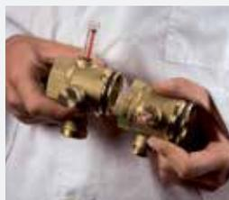
1. Совместить сопрягаемые модули с соосным поворотом 90°, с небольшим усилием соединить до упора и повернуть на 90° относительно оси.
