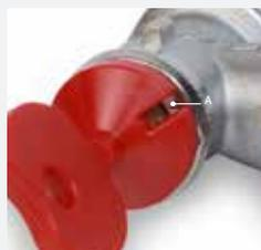
2. Повернуть шток винта специальным регулировочным ключом. Установить требуемый номер преднастройки, указанный на регулировочном ключе, напротив метки А на корпусе клапана.
