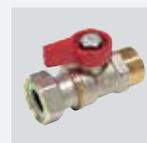
Прямой стандартнопроходной шаровой кран с наружной резьбой и накидной гайкой с плоской прокладкой, для гидравлических систем, латунный никелированный с алюминиевой флажковой рукояткой.
