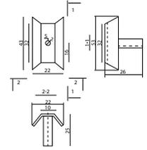
H=22 мм, W= 43мм, Винт М4-30
