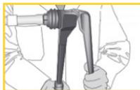
3. Вставьте конец трубы на насадку расширителя.
