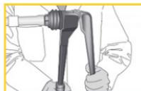
4. Расширьте конец трубы в 3 приема каждый раз поворачивая инструмент на 30°.
