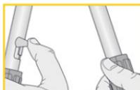
7. Переключите рычаг в верхнее положение для запрессовки соединения.
