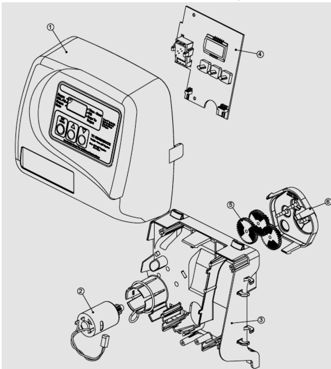
**БЛОК НАСАДКИ ПРИВОДА WS1TC, ПЛУНЖЕР НИСХОДЯЩЕГО ПОТОКА, ПЛУНЖЕР РЕГЕНЕРАНТА И БЛОК НАБОРНОГО МОДУЛЯ**
