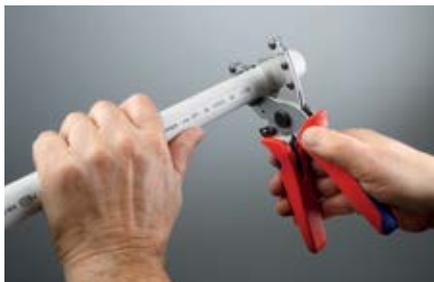
Отрезание трубы при помощи труборезных ножниц
