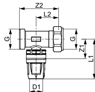
**Коллектор с накидной гайкой, 2 контура**
