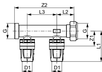
**Коллектор с накидной гайкой, 3 контура**
