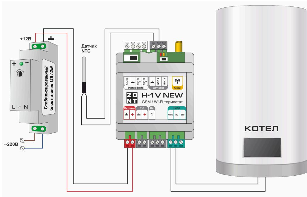
К Термостату можно дополнительно подключать оригинальные цифровые устройства ZONT, датчики температуры и прочие датчики различного назначения. Для этих целей предназначен один аналоговый вход и цифровые интерфейсы RS-485, K-Line, 1-wire.
