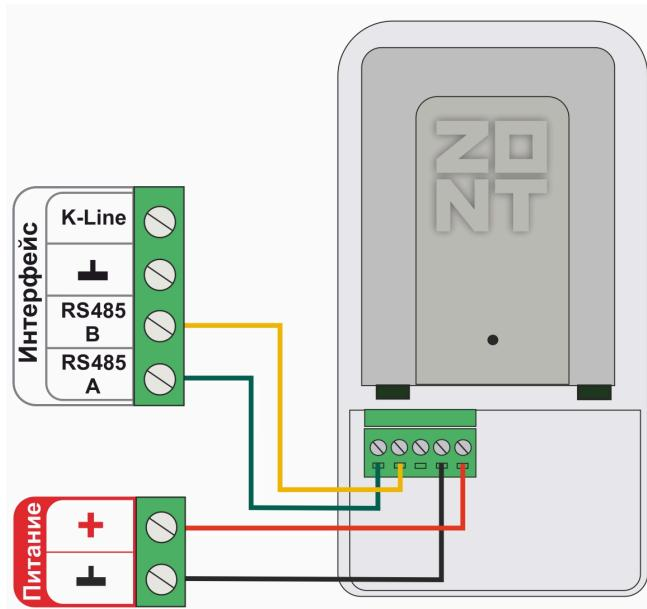
Схема подключения радиомодуля по K-Line:
