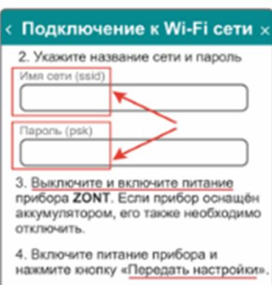
Разместить смартфон в непосредственной близости от контроллера ZONT и в настройках подключения указать название сети и пароль. Затем нужно выключить и включить питание (основное и резервное) Контроллера ZONT и нажать кнопку "Передать настройки" - в течении 2-х минут подключение будет установлено.
