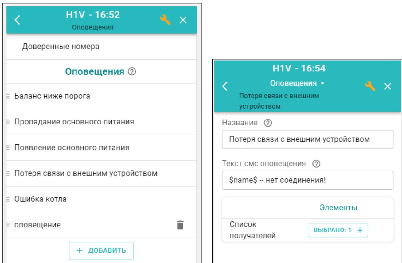
Дополнительно можно настроить SMS-оповещения произвольного содержания. Такие оповещения можно удалять и корректировать.
