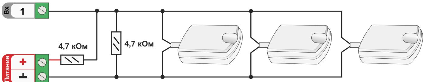
**ВНИМАНИЕ!!!** Датчики протечки Астра 361 имеют полярность. При несоблюдении полярности датчик не имеющий контакта с водой показывает сработку.
