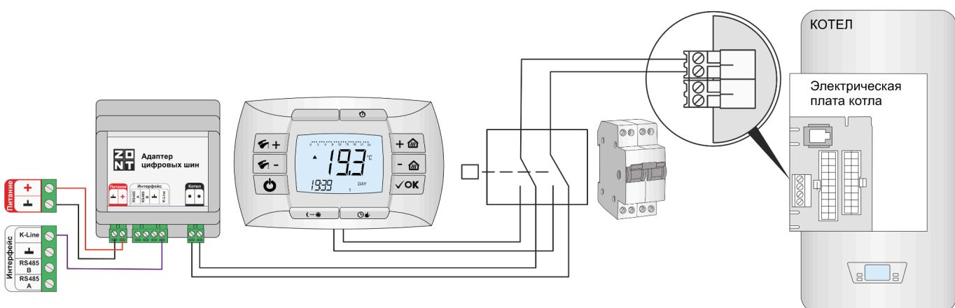
Для включения ручного режима управления, нужно сначала выключить котел, потом перевести переключатель в положения связи котла с панелью и снова включить котел.
