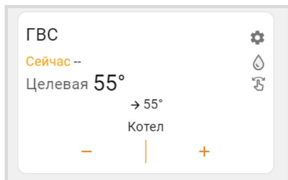
При отсутствии данных от датчика температуры, по которому производится регулирование в контуре, вместо значения температуры будет отображаться прочерк **Сейчас --**
