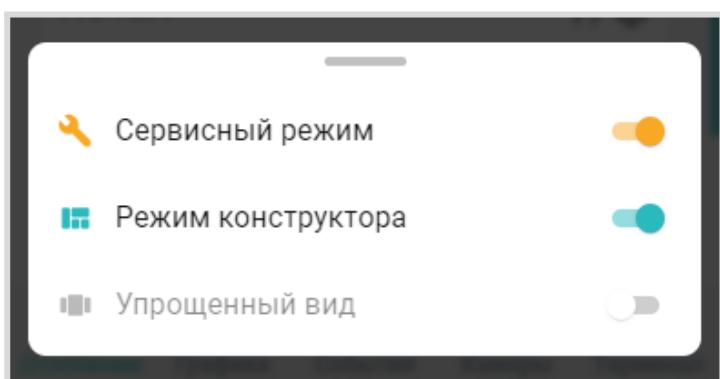
**Сервисный режим** открывает доступ к настройкам Термостата, определяющим алгоритм его работы. Выключение сервисного режима оставляет только пользовательские настройки. Доступ в сервисный режим можно закрыть индивидуальным паролем. В заводской конфигурации прибора установлен пароль **admin**.
