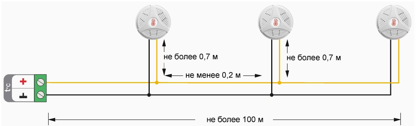
Подключение датчиков по трехпроводной схеме:
