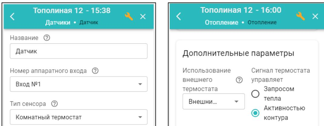
“Запрос на тепло” в контуре Отопление, управляемом по комнатному термостату, всегда равен значению *верхней границы температуры теплоносителя*, указанного в настройке контура. На панели управления контуром будет отображаться признак регулирования по термостату
