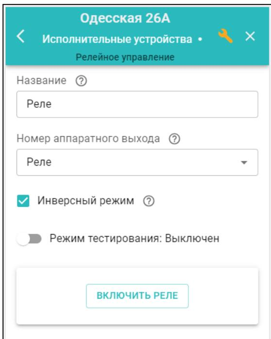
**Инверсный режим** – параметр защиты котла от выключения при отключении напряжения питания Термостата. При таком событии релейный выход остается замкнутым, оставляя котел во включенном состоянии. При этом котел необходимо подключать к клеммам Н3-ОБЩ релейного выхода Термостата.
