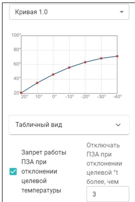
**Примечание:** Если выбрано регулирование “по воздуху” или “по воздуху с ПИД”, то при необходимости быстрого нагрева помещения надо указать при какой разнице между фактической и целевой температурами отключать ПЗА, чтобы котел мог работать на полную мощность.
