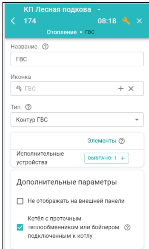
Настройка контура ГВС в конфигурации Термостата заключается в активации параметра “Котел с проточным теплообменником или бойлером подключенным к котлу”. Исполнительным устройством такого контура должен быть указан “Адаптер ЦШ”.
