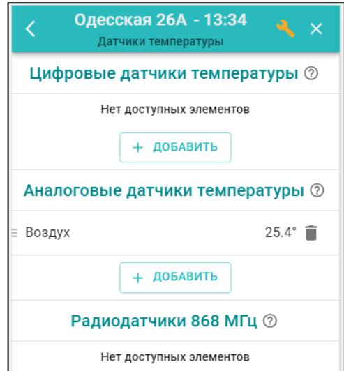
**Аналоговые датчики температуры NTC-10** к Термостату можно подключить в количестве не более 3-х шт. В комплект поставки входит один датчик. Датчики NTC-10 рекомендуется подключать к специальными входам Термостата, имеющим маркировку NTC
