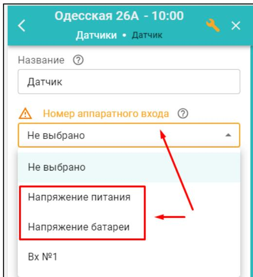
Для формирования оповещений об отключении и восстановлении напряжения необходимо указать нижний и верхний пороги срабатывания функции контроля и включить параметр “Событие на сервер при срабатывании”.
