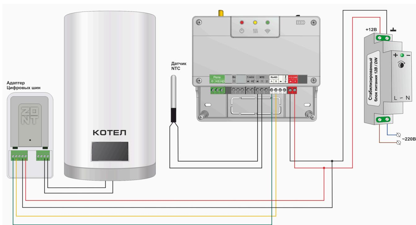
При таком подключении Термостат считывает из цифровой шины котла фактическую температуру теплоносителя и другие параметры его работы, сравнивает целевую и текущую температуры воздуха в помещении или теплоносителя в системе отопления и рассчитывает температуру теплоносителя, оптимальную для поддержания целевой температуры действующего режима отопления.
