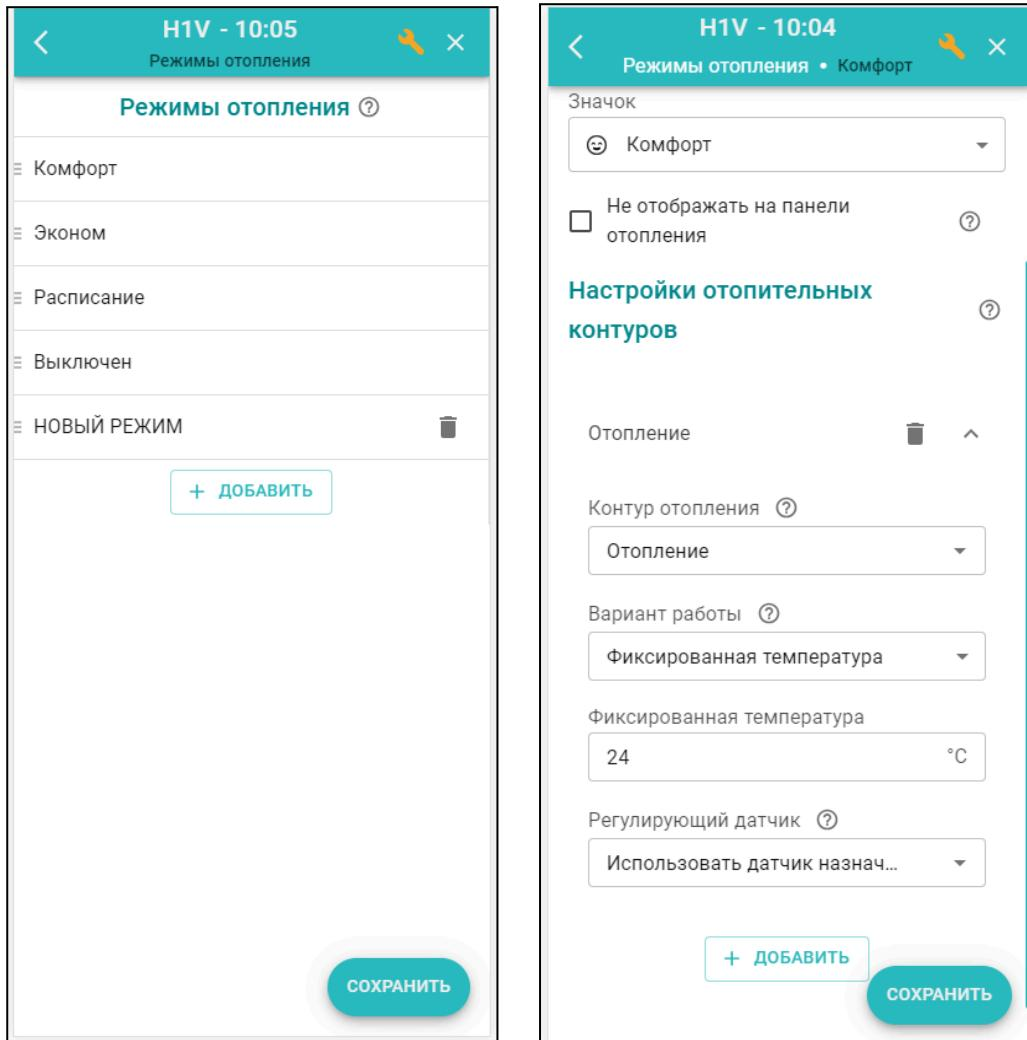
Каждый режим определяет целевую температуру для работы котла на Отопление и на ГВС.
