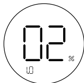
Рис. 28. Настройка отопительной кривой.
