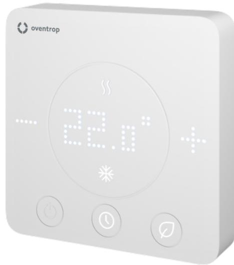
Комнатные термостаты ClimaCon F служат для регулирования температуры в системах отопления и охлаждения в коттеджах или квартирах. Температура в помещении регулируется вентилем, управляемым комнатным термостатом с помощью термоэлектрического привода. При достижении температуры в помещении температуры настройки, вентиль закрывается.
