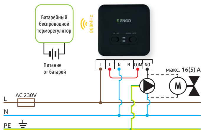
б) Схема подключения приёмника к насосу/сервоприводу
