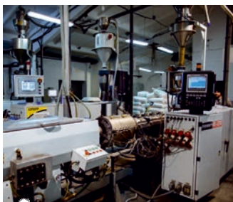
Цех по производству канализации
