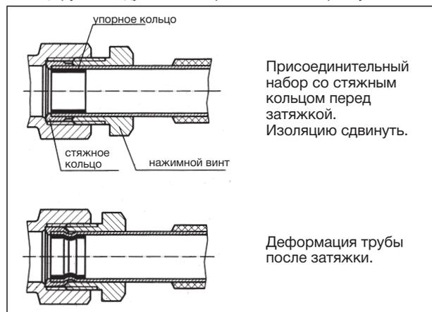
При соединении с тонкостенными или мягкими трубами необходимо использовать упорные гильзы. Упорные гильзы калибруют трубу и придают необходимое усиление стенке, чтобы провести затяжку. С толстостенными трубами упорные гильзы не используются. Следует соблюдать рекомендации производителя. При необходимости провести предварительные гидравлические испытания.
