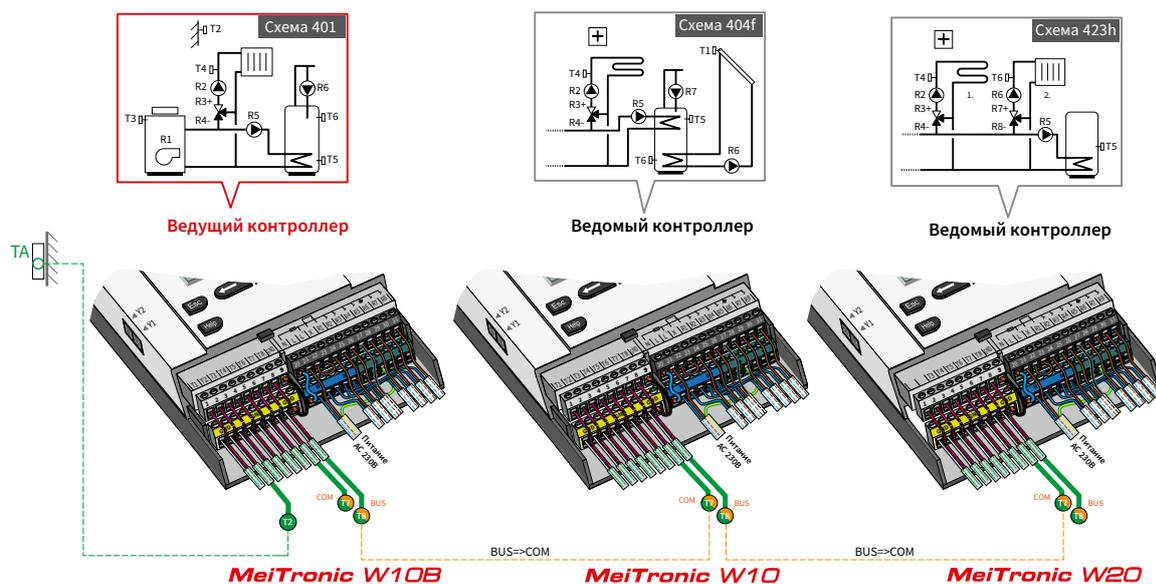
**Примечание:** можно назначить любой из контроллеров Meibes MeiTronic в качестве «Ведущего контроллера» в зависимости от типа и схемы подключения источника тепла.
