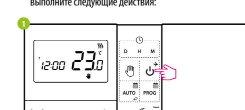
Нажмите кнопку чтобы перейти в режим выключения регулятора.
