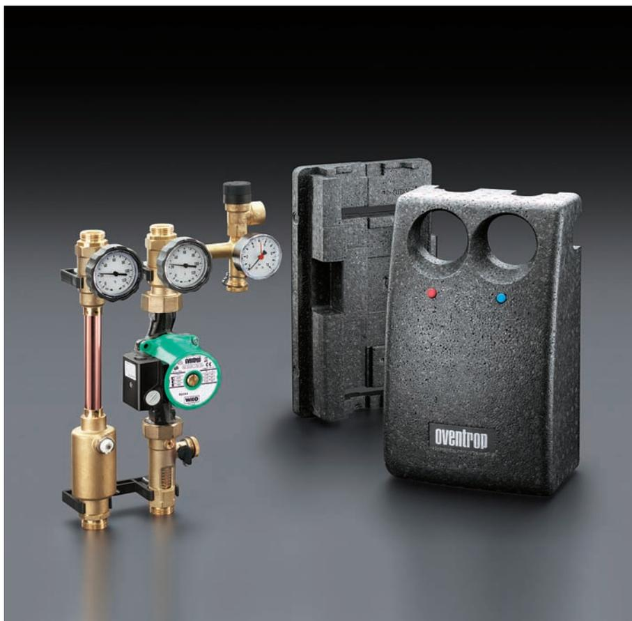
1 Станция „Regusol L-180“ Ду 25 с группой безопасности (длина насоса 180 мм) и воздухоотделителем на подающей линии. Подключение к солнечному контуру Ду 25 с помощью присоединительных наборов „Regusol“. Полностью смонтирована и проверена на герметичность, с группой безопасности и возможностью подключения к расширительному баку.
