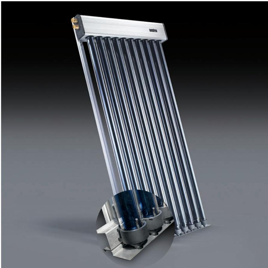
Трубчатый коллектор „ОКР-10/20“ состоит из вакуумированных трубок со встроенным элементом „Heat-Pipe“, в котором осуществляется постоянный перенос тепла. Исходя из конструкции, коллектор может быть установлен на скатных или плоских крышах, фасадах, или в произвольном месте под углом от 15° до 75°. Трубчатый коллектор может использоваться для нагрева контура водоснабжения, воды в бассейнах, поддержки контура отопления, а также получения тепла для технических нужд.
