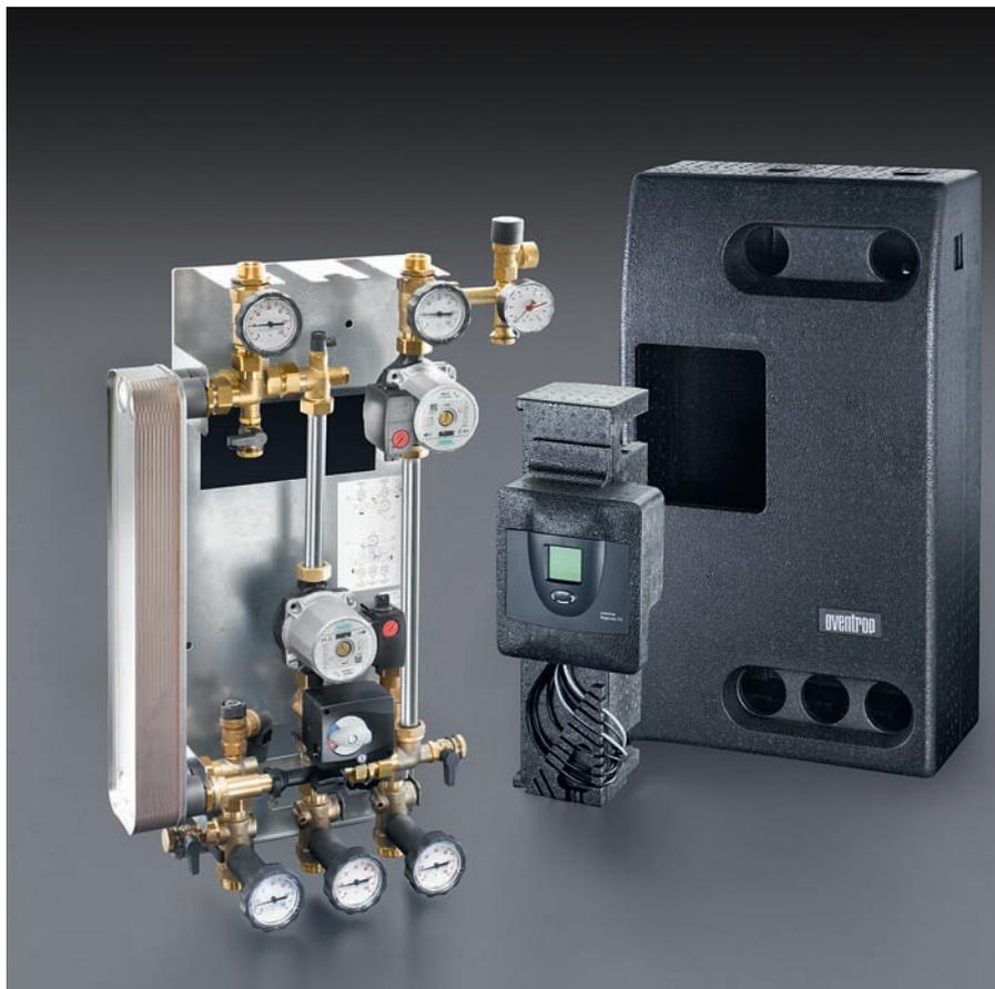
Амбатурная группа с электронным контроллером, с теплообменником, с трехходовым переключающим вентилем на два вторичных контура для контролируемой передачи тепловой энергии солнечного (первичного) контура в моновалентный аккумулятор тепла (вторичный контур); напр. в существующий аккумулятор без непосредственного подключения к солнечному контуру.
