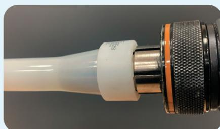
➤ Расширьте трубу вместе с кольцом необходимое количество раз в соответствии с таблицей. Расширительная головка должна делать поворот после каждого расширения.
