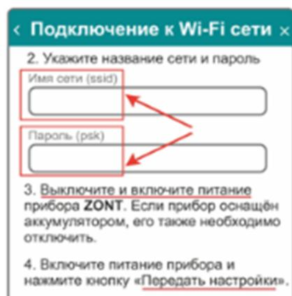
Разместить смартфон в непосредственной близости от контроллера ZONT и в настройках подключения указать название сети и пароль. Затем нужно выключить и включить питание (основное и резервное) Контроллера ZONT и нажать кнопку "Передать настройки" - в течении 2-х минут подключение будет установлено.
