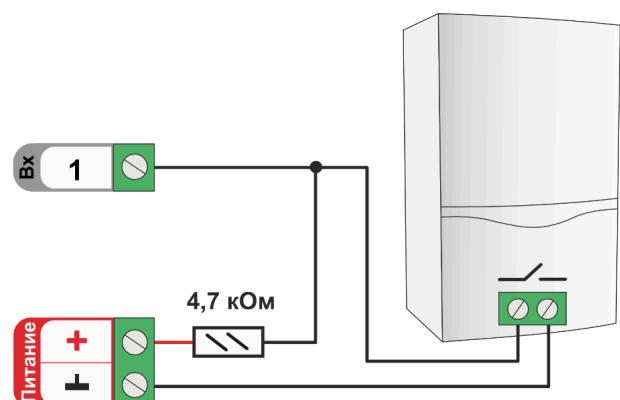
Для сигнала **“Авария котла -”** расчет пороговых значений контролируемого напряжения проводится по формулам:
