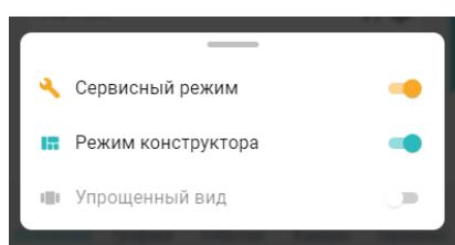
**Сервисный режим** открывает доступ к полным настройкам Контроллера. Выключение сервисного режима оставляет только пользовательские функции. Доступ в сервисный режим
