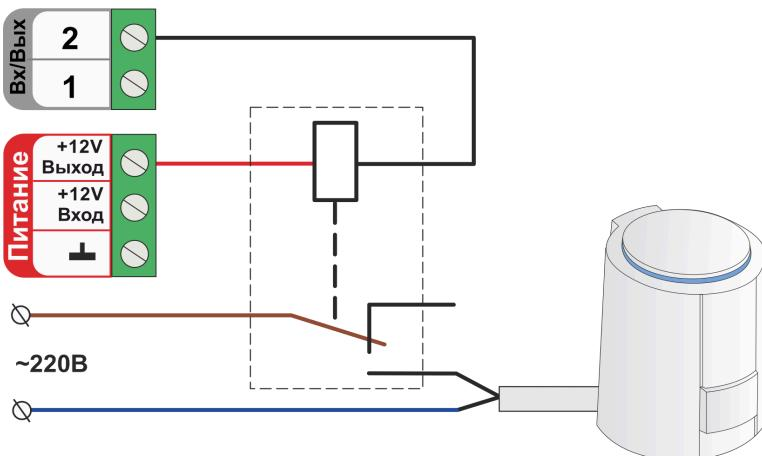
В качестве дополнительного промежуточного реле рекомендуется использовать **реле 12V DC артикул ML00000291**. Ссылка на карточку товара ресурс Zont-online.ru [Реле промежуточное на DIN-рейку, 12V DC в сборе](#).
