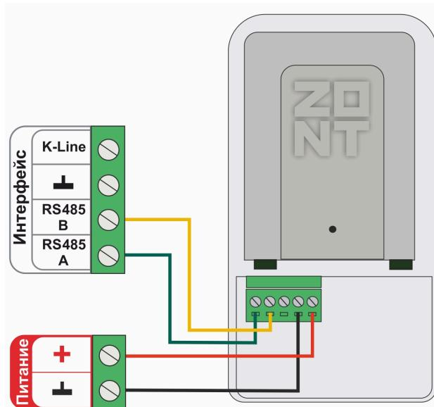
Схема подключения радиомодуля по K-Line:
