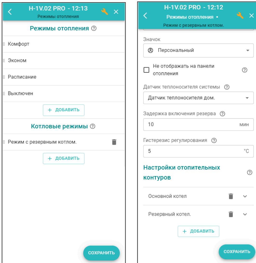
**Датчик теплоносителя системы** – источник информации о температуре теплоносителя в гидрострелке. Это отдельный датчик, контролируемый входом Контроллера. Физически датчик устанавливается на гидрострелке в зоне подачи теплоносителя.
