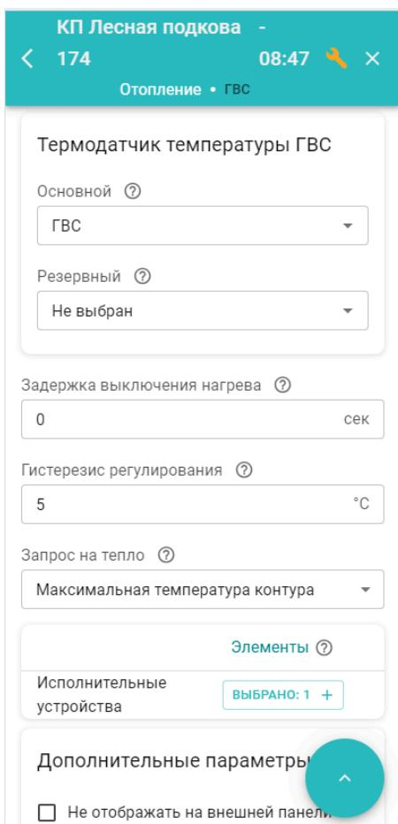
**ВНИМАНИЕ!!!** В контуре ГВС с БКН за гидрострелкой гистерезис поддержания горячей воды отслеживается только в сторону уменьшения от целевой температуры. Т.е. если целевая температура ГВС – 50°C, а гистерезис – 5°C, то запрос тепла в контур котла будет отправляться при температуре горячей воды 45°C и сниматься при температуре 50°C.
