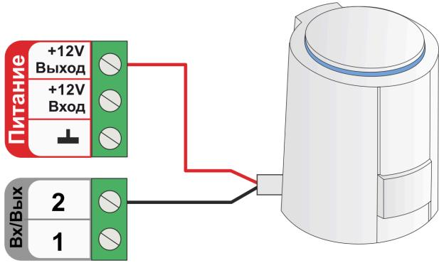
Схема подключения к релейному выходу:
