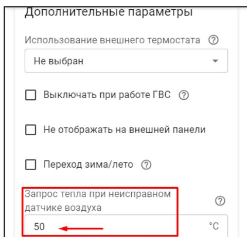
**Примечание:** Если в контуре включено управление с учетом ПЗА, то значение “запроса на тепло” определяется по выбранной кривой ПЗА.
