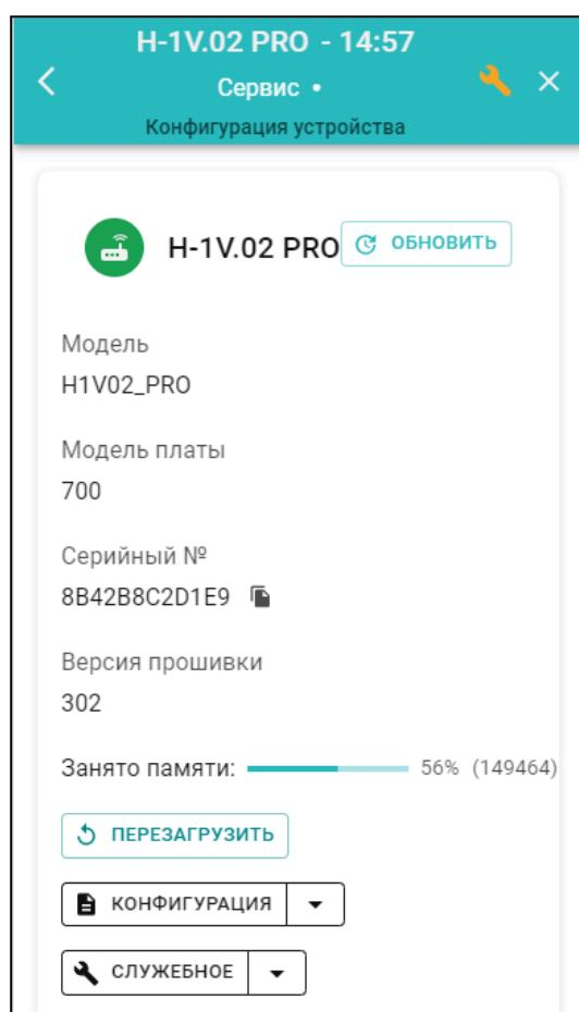
**Конфигурация** позволяет скачать в отдельный файл конфигурацию из Контроллера или из архива данных на сервере и загрузить в Контроллер конфигурации из ранее сохраненного файла.
