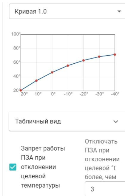
**Примечание:** Если в контуре выбрано регулирования “по воздуху” или “по воздуху с ПИД”, то при необходимости быстрого нагрева помещения надо указать при какой разнице между фактической и целевой температурами отключать ПЗА, чтобы котел мог работать на полную мощность.
