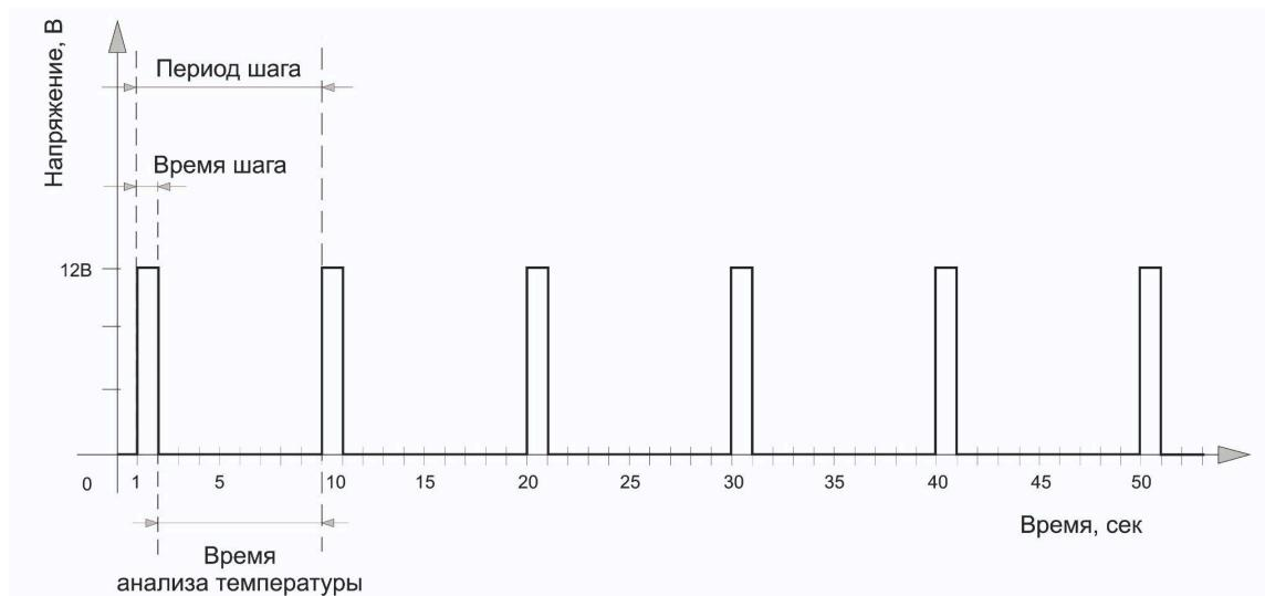
**Период шага** для управления трехходовым краном настраивается пользователем в пределах от 10 до 180 секунд. Для управления двухходовым краном (термоэлектрическим клапаном) он всегда равен 10 сек. и не может быть изменен настройкой)
