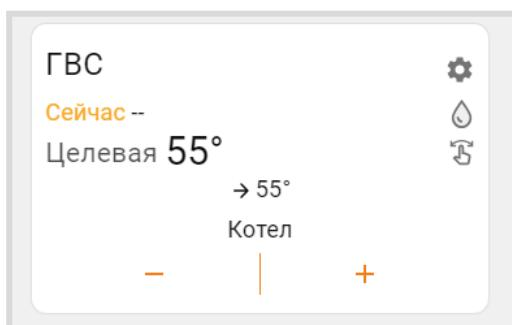
При отсутствии данных от датчика температуры, по которому производится регулирование в контуре, вместо значения температуры будет отображаться прочерк
