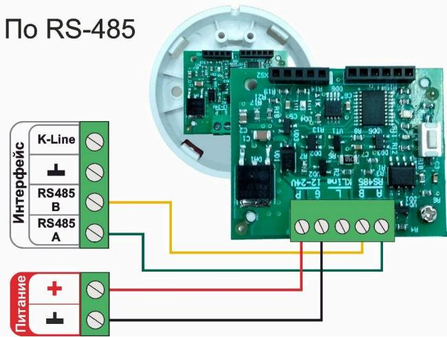
Допускается подключение только оригинальных датчиков температуры ZONT МЛ-778 и датчиков температуры / влажности МЛ-779. Сторонние датчики других производителей по интерфейсу RS-485 с Контроллером работать не могут.
