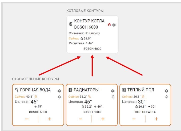
Параметр “Запрос на тепло” применяется только в Отопительных контурах, где для поддержания целевой температуры требуется повышать температуру на подаче котла. Значение “запроса на тепло” устанавливается настройкой и зависит от выбранного алгоритма терморегулирования:
