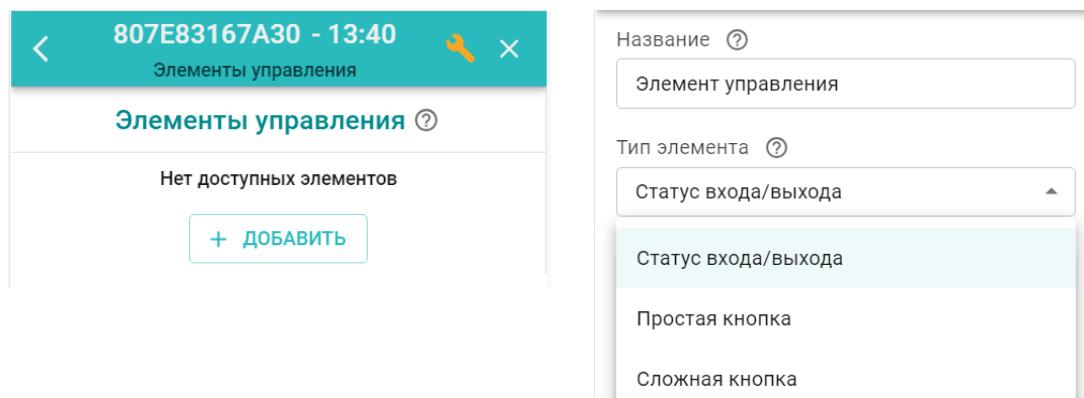
Элемент управления может быть “Статусом входа или выхода” и отображать текущее состояние универсального входа или релейного выхода Контроллера.
