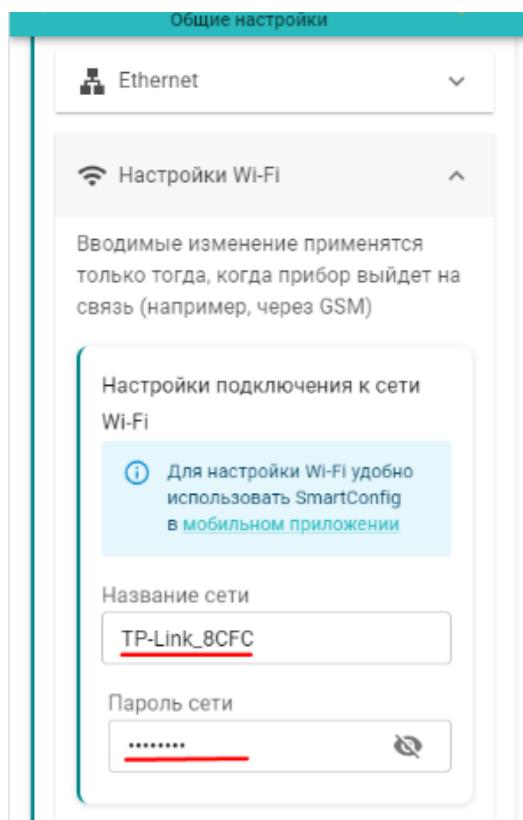
Если в Контроллер уже установлена активная Сим-карта и связь с сервером по GSM есть, то для подключения к сети Wi-Fi надо в общих настройках прибора указать название и пароль сети и сохранить введенные данные. Контроллер разорвет соединение с сервером по каналу GSM и установит соединение по сети Wi-Fi. При этом GSM канал связи будет в резерве.
