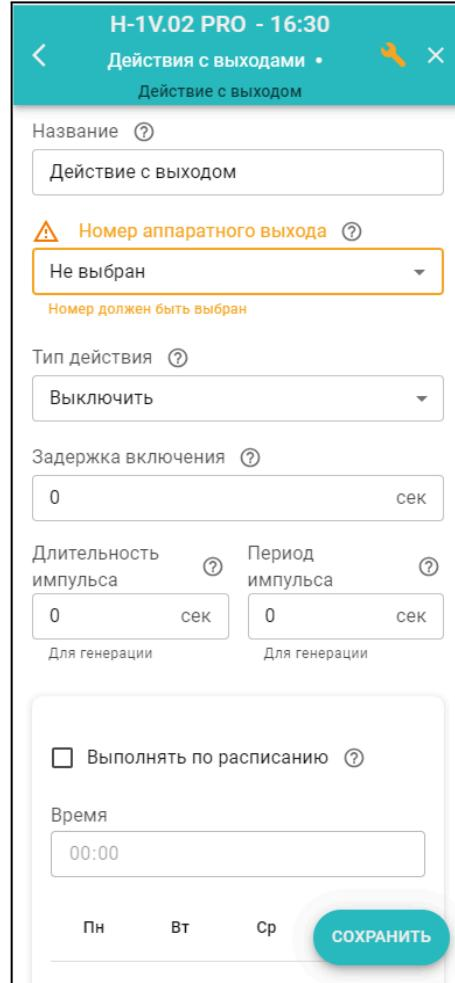
**Примечание:** Управление выходом генерацией импульсов не имеет ограничения по времени и будет отключено только при перезагрузке Контроллера. Для отключения генерации с кнопки или по другому событию, нужно создать еще одно действие с выходом “Выключить” и применить его для выхода с генерацией.
