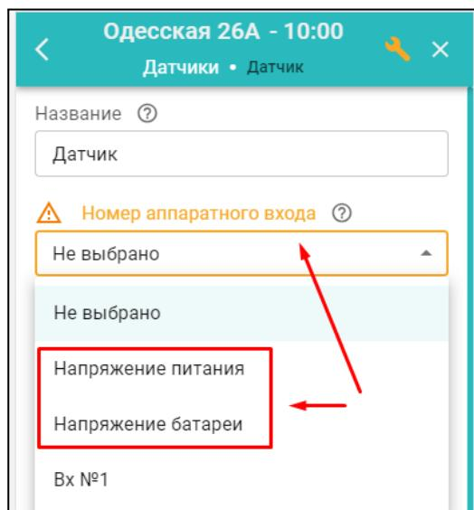
Для автоматического контроля наличия основного и резервного питания Контроллера нужно в блоке настроек “Управление/Датчики” выполнить две настройки:
