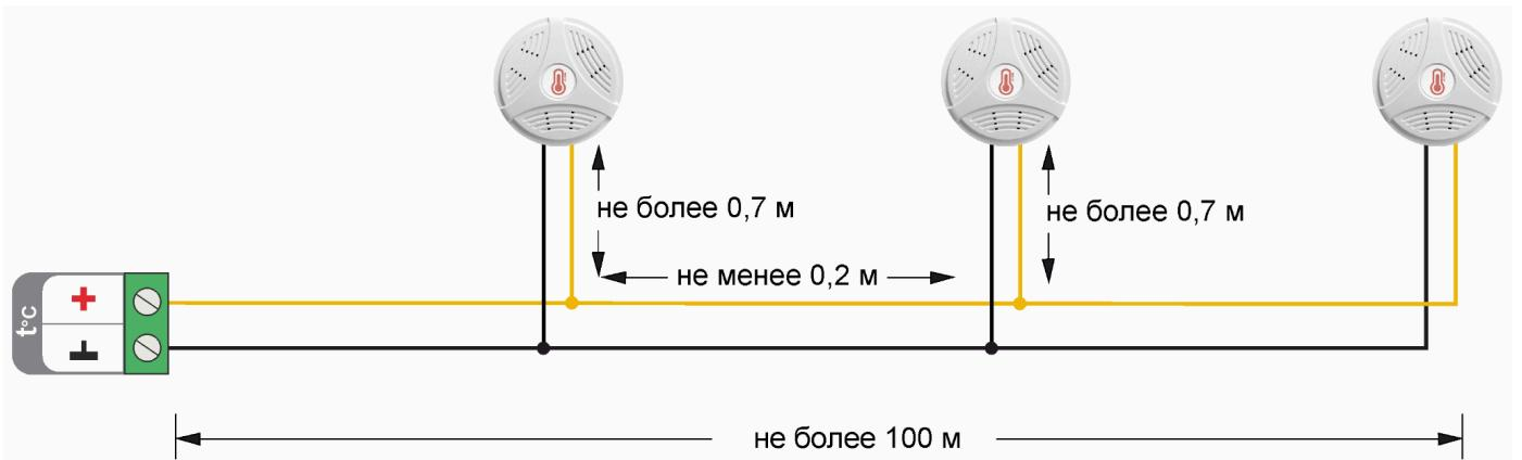
Подключение датчиков по трехпроводной схеме:
