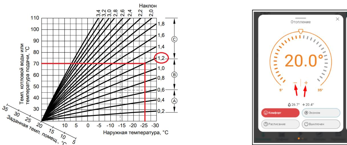
Значение параметра “запрос на тепло” в отопительном контуре с ПЗА может быть задано только “**Требуемая теплоносителя**” или “**Требуемая теплоносителя+XX**”. Фактическая температура теплоносителя в таком контуре будет определяться выбранной кривой и заданным способом регулирования:
