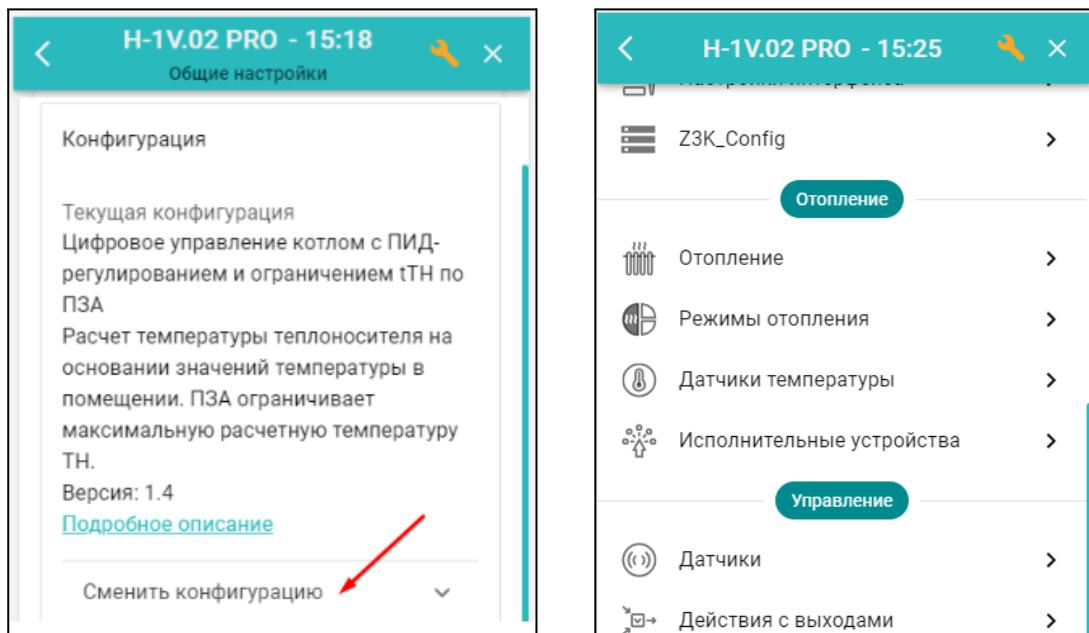
К каждой конфигурации есть текстовое описание ее алгоритма управления котлом и схема подключения к Контроллеру необходимых датчиков температуры. Типовые конфигурации различаются по целям и способам управления котлом:
