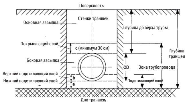
РИС. 3. УСТРОЙСТВО ТРАНШЕИ
