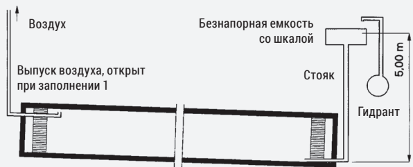
РИС. 10. ПРОВЕРКА ГЕРМЕТИЧНОСТИ
