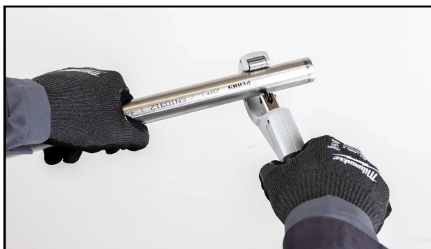
Рис. 1.1 Обрезка трубы d15-54 мм
