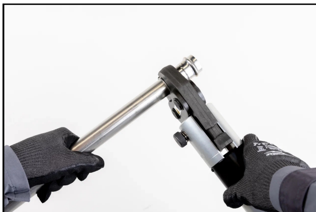
Рис. 6 Запрессовка (обжим) соединения
