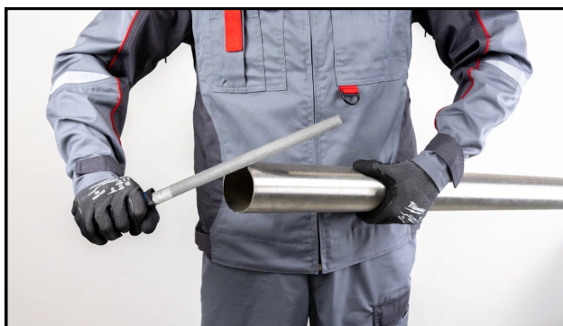
Рис. 2.2 Снятие фаски с трубы d76,1-108 мм
