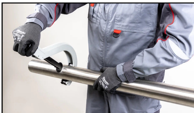
Рис. 1.2 Обрезка трубы d76,1-108 мм
