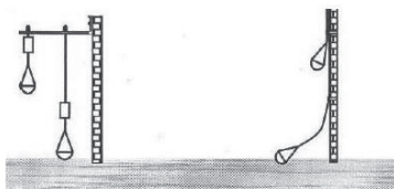
Рис. 2 Монтаж поплавкового выключателя MS M2
